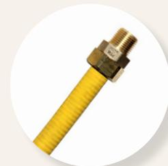
Los conectores flexibles de gas natural son tubos de metal ondulado donde se conectan los aparatos de gas a las tuberías de suministro de gas natural de una casa o edificio. Algunos conectores flexibles son viejos hechos de latón sin revestimiento y pueden corroerse o romperse. Tenga cuidado al mover un aparato para revisar el conector del gas, esto puede causar que el conector se rompa y potencialmente resultar en una fuga de gas o un incendio.
